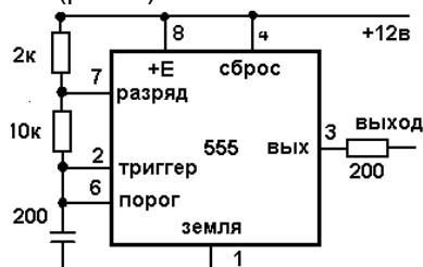
Рисунок 6 – Вариант реализации генератора на микросхеме таймера 555
